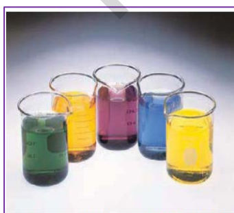
Υδατικά διαλύματα ενώσεων του Cr. Από αριστερά: \text{CrCl}_2 , \text{K}_2\text{Cr}_2\text{O}_7 , \text{Cr}(\text{NO}_3)_3 , \text{CrCl}_3 , \text{K}_2\text{CrO}_4 .
